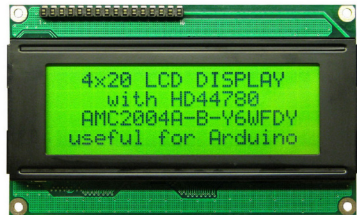
Een LCD display met 4 regels van 20 karakters
